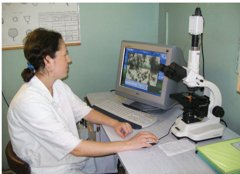
Инженер-бактериолог ИКХБЛ Викуловская Галина Владимировна проводит микроскопирование активного ила
