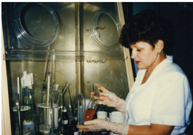
Ведущий инженер-химик Уманская Людмила Константиновна проводит экстракцию по определению тяжелых металлов
